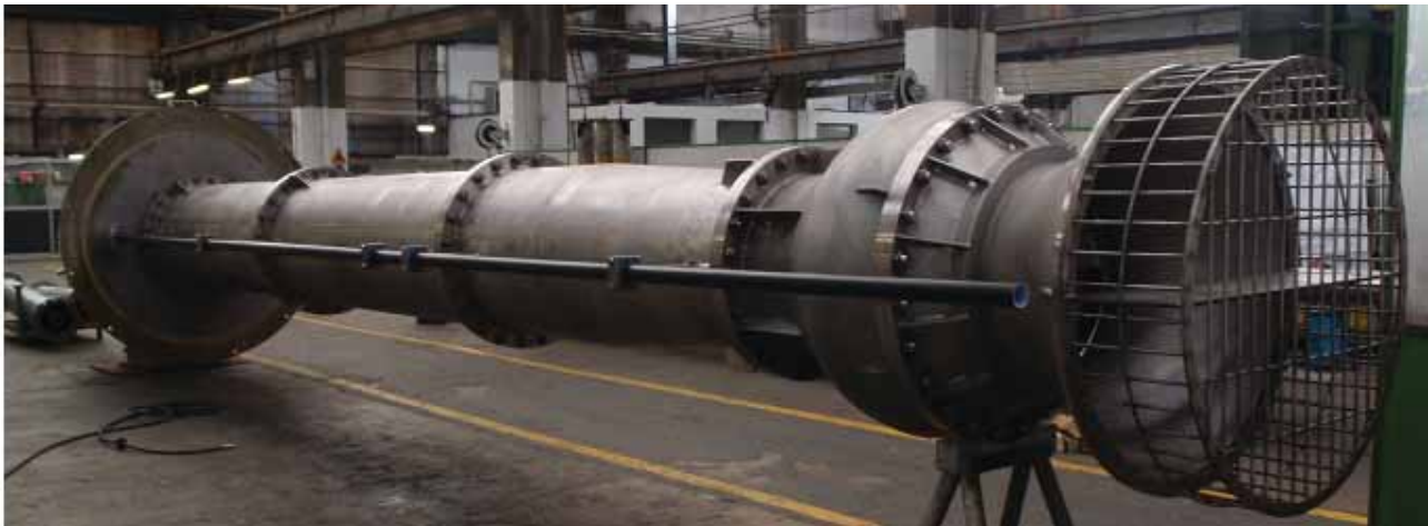
图 5 某 LNG 项目中的海水循环泵
