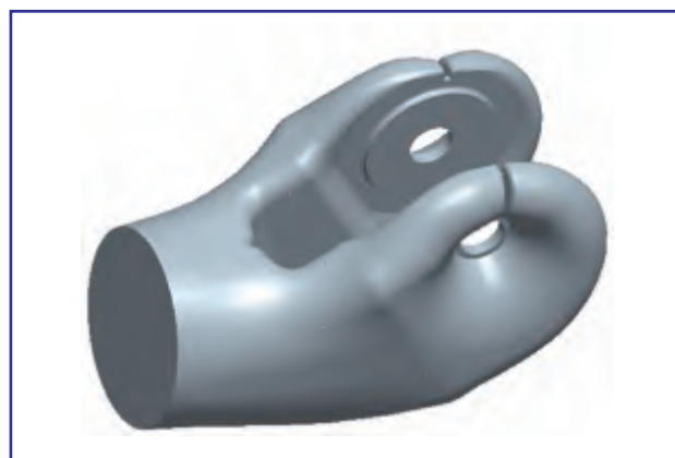
图1 双吸式离心泵吸入室过流区域
