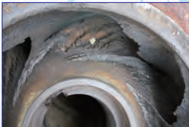
图1 双吸泵叶轮汽蚀破坏
